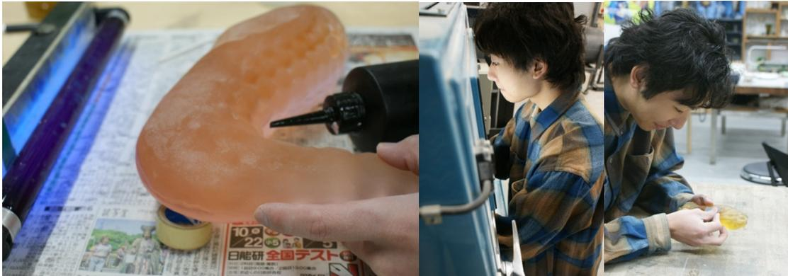
図 14.(左) フォトボンドで半分になっていたパーツを接着する。
