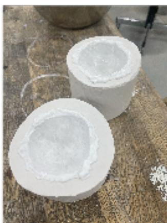
図 24,(中) パウダー状のガラスをホイップし、側に塗り上げる。
