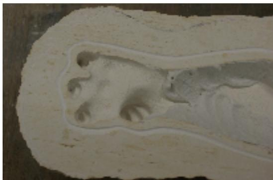
図 34,(左) 手の指の部分は細かく奥が深いため、ガラスが多くなりすぎないように心がける。
