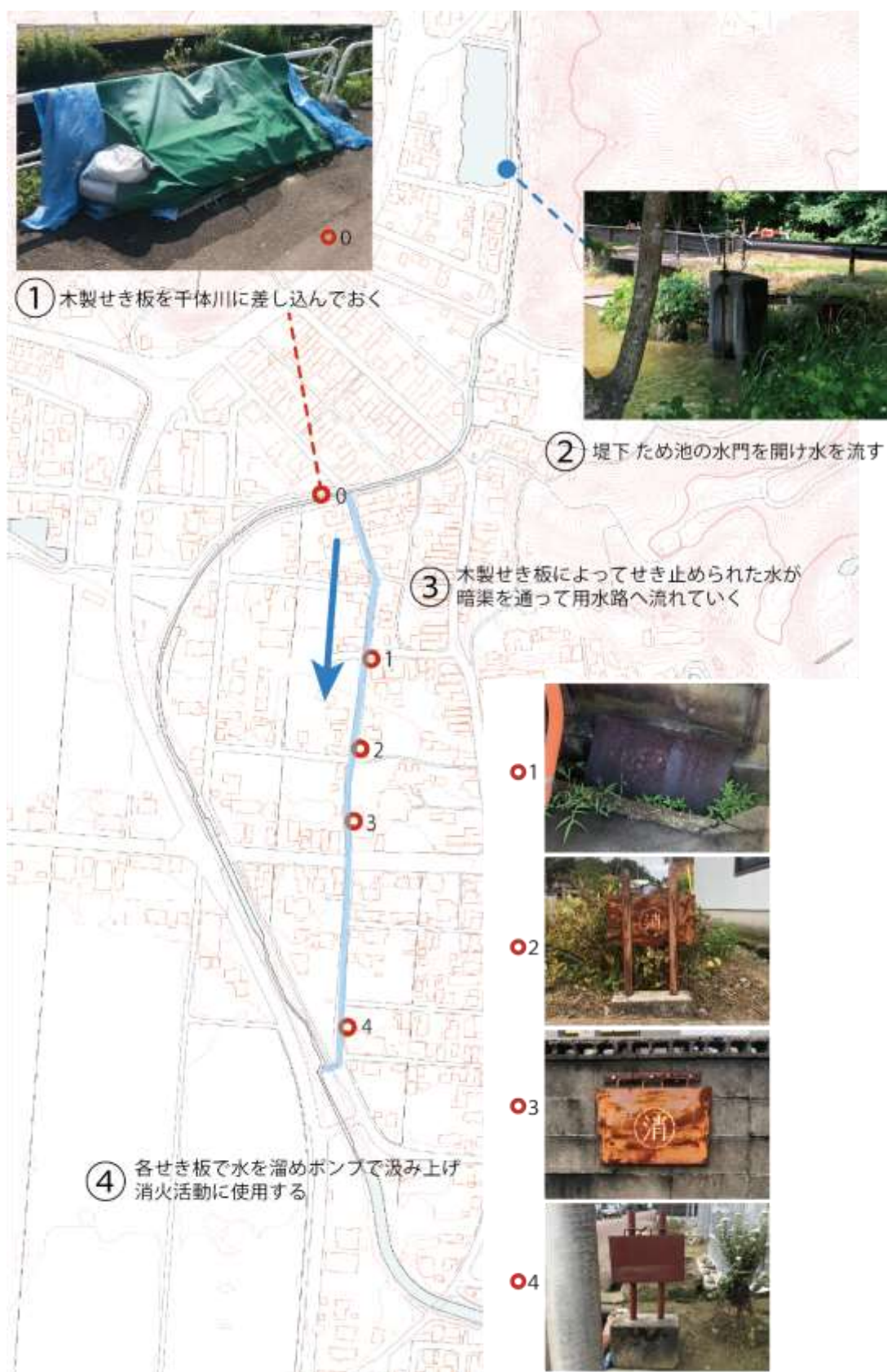
図8 堤下ため池が水源となるせき板の使用手順
