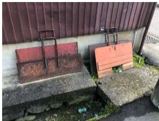
写真5 栃尾本町に見られるせき板
