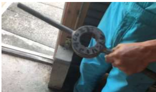
写真 26 堤下ため池の水門用ハンドル
