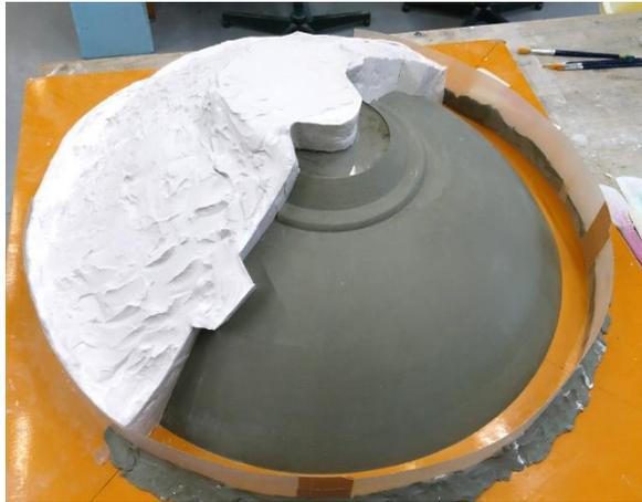
◀器の底を持って型に置けるよう、底部分の形状を工夫する。
