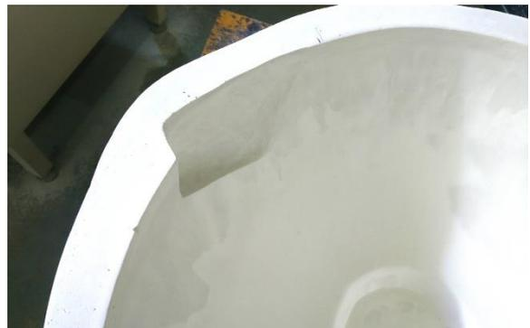
前回はバラバラに割れていた為、ひとつずつ型に沿わせることが出来た。しかし今回はある程度接着されている状態に加え、薄い縁を持つことが出来ない為、一塊の石膏型に入れる作業に難儀した。次点で同じような状態になった際には、割り型にする等の対策を練る。
