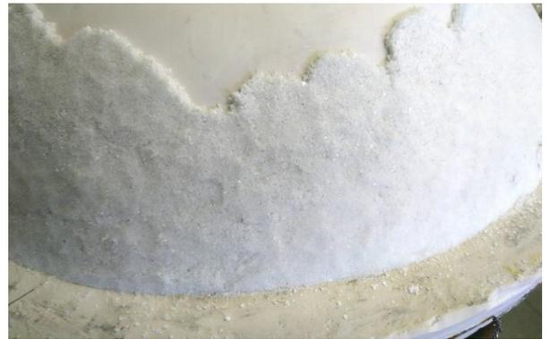
電気炉に入れ、トップ 899°C、5h キープしたのち、電源を切り電気炉の蓋を一気に開ける
