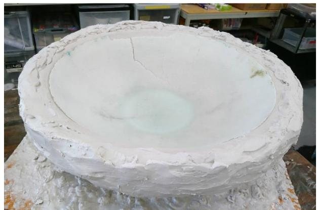
うまく添わせることが出来た。石膏の割れ目から電気炉内で崩壊しないよう、石膏で補強する。
